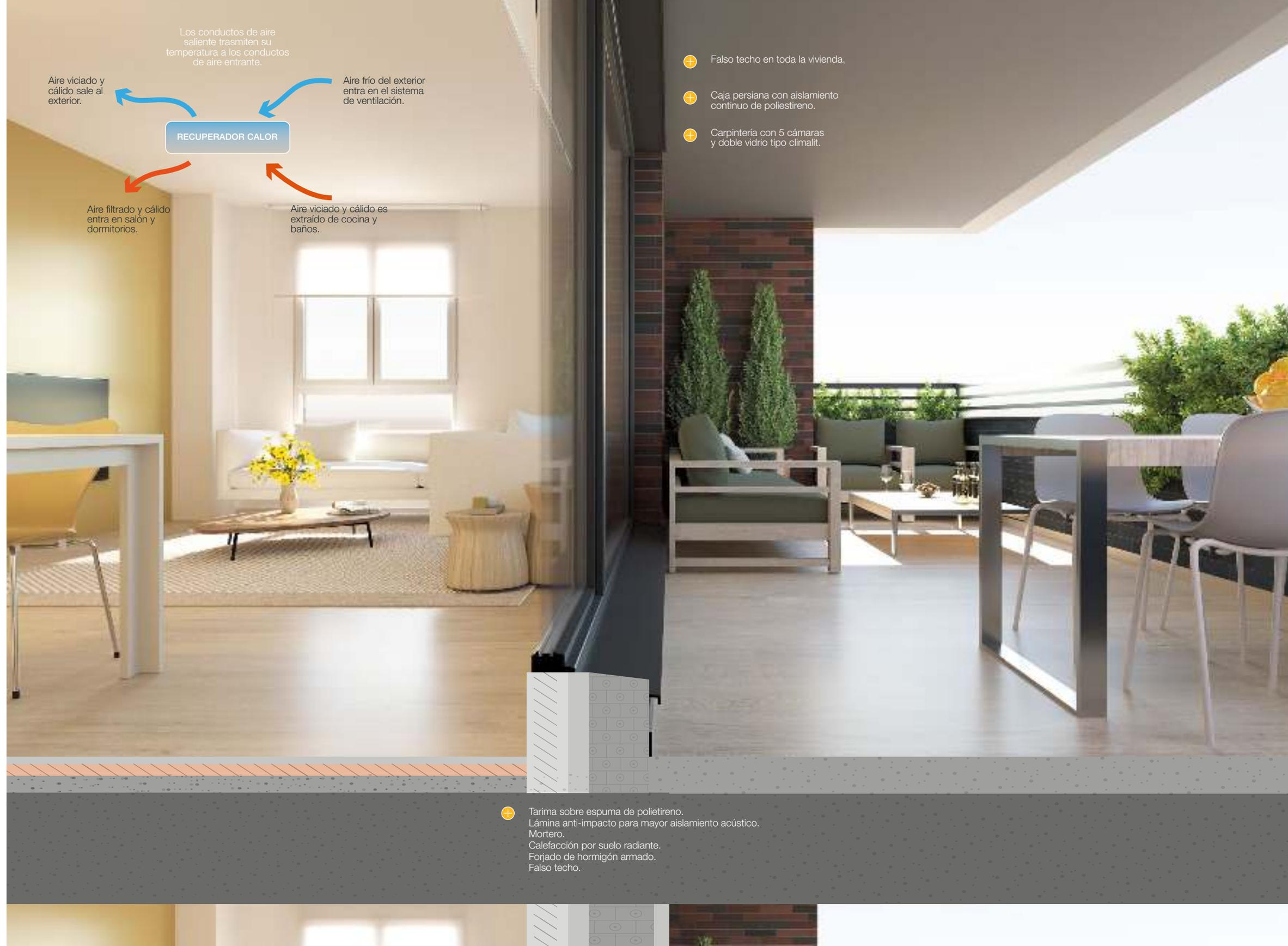
Los conductos de aire saliente transmiten su temperatura a los conductos de aire entrante.
